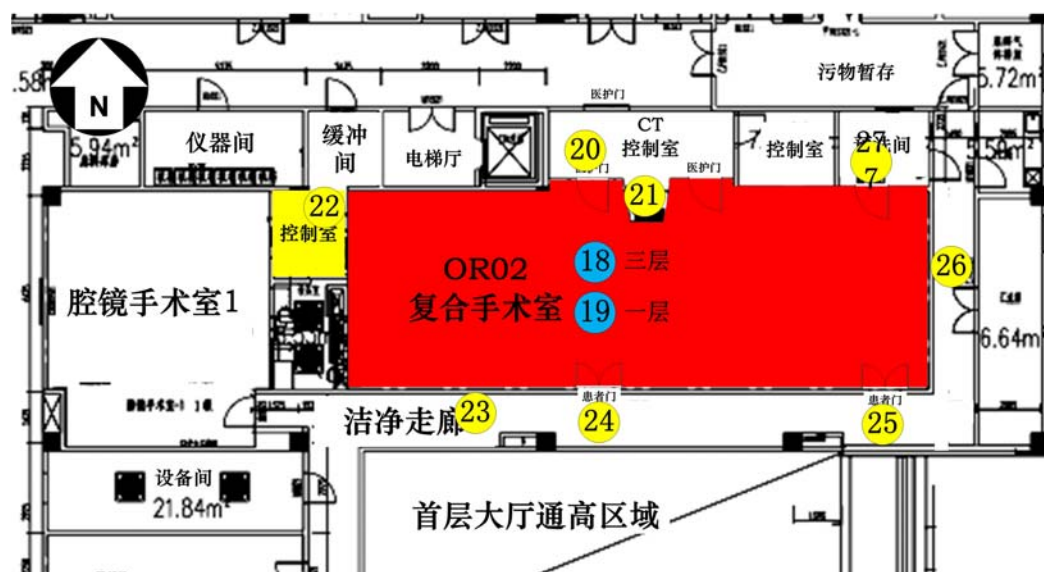
图 12-2 复合手术室监测点位示意图（图中圆圈数字为监测点位）
