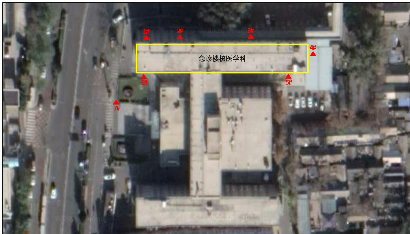
图 8-1 环境 \gamma 辐射剂量率现状水平监测布点示意图
