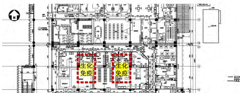
图 2-5 急诊导管室 1 的楼下、楼上下相邻关系示意图
