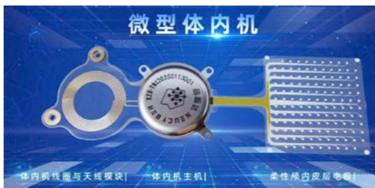
柔性 ECoG 的高性能全植入式无线脑机接口样件及脑机植入示意图
