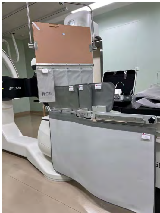
铅玻璃吊屏和铅橡胶吊帘、床侧铅橡胶挂帘和铅防护屏
